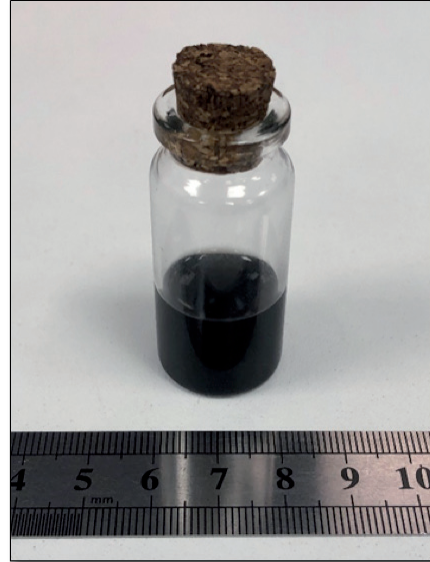
Figura 2: Nanopulverizado del grafeno en PEG como solvente. El nanopulverizado se realizó mediante técnicas de desintegración por ultrasonido a altas frecuencias. Nanomolido en estado coloidal. Fuente: Imagen propia
